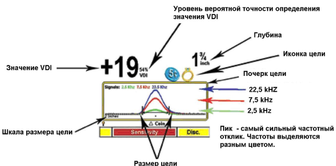
Большинство металлических сплавов производят ряд гладких изгибов, подобных единственному горбу верблюда, немного различных по высоте (силе сигнала) в каждой отдельной частоте. Монеты на ребре или неправильных форм часто имеют на частотном анализаторе впадину
