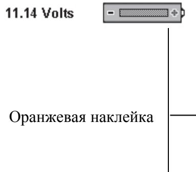
Детектор Spectra имеет два комплекта батарей. Заряжаемые никелево металгидридные (NiMH) батареи (оранжевая наклейка) требуют первоначальной зарядки в течение 3-4 часов.
