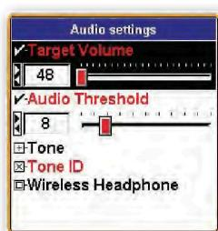
• **Tone or Pitch** – Высота тона звукового сигнала от цели. Стрелками вправо\влево производится регулировка тона "звукового сигнала" и его высоты ("звуковой сигнал" производит металлическая цель). Выберите удобную для Вас высоту звукового тона. Во время регулировки можно слышать образец текущего тона, выдвинув вперед триггер.
