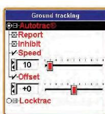
• Autotrac (автоподстройка) – предусматривает автоматическую балансировку на грунт.
