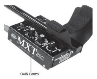
С помощью ручки GAIN вы включаетевыключаете металлоискатель и выбираете
