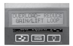
Целью увеличения усиления сигнала является достижение максимальной глубины обнаружения без появления на дисплее предупреждающей надписи о перегрузке схемы.
