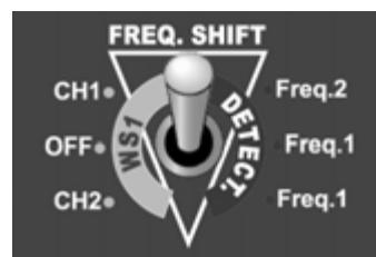
Если Вы работаете ОДИН без беспроводных наушников WS1, ищите при среднем положении переключателя (OFF/Freq.1). Устройство вывода сигнала на беспроводные наушники отключится и не будет потреблять энергию. На детекторе будет установлена частота 1.
